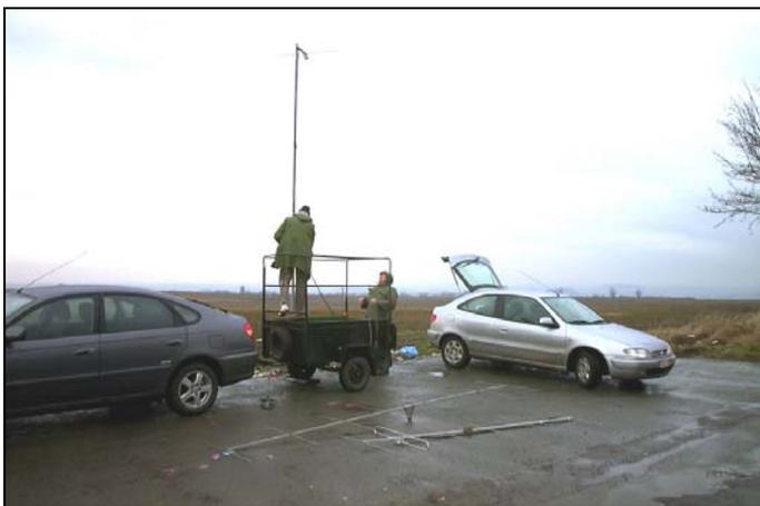
Une fois bien réglée, nous avons procédé aux mesures d'usage afin de mieux connaître notre antenne. Nous sommes restés sur le site de réglage où nous étions en vue directe d'un ami radioamateur disposant d'un spectrum analyzer et d'une antenne de réception.
