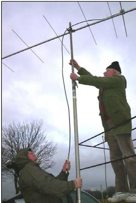
Nous avons procédé à ces réglages en rase campagne. Nous disposions d'un émetteur 144 MHz, d'un wattmètre BIRD mesurant la puissance rayonnée et la puissance réfléchie.
